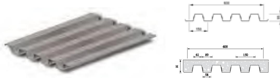
A prescindere dalla maglia strutturale che l'edificio andrà a configurare, si ipotizza una tipologia di lamiera grecata collaborante da utilizzare per ottenere un solaio con effetto diaframma, e cioè rigido nel proprio piano.
