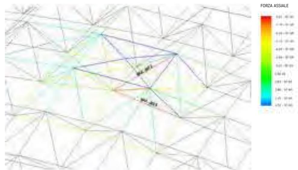
Le dimensioni dei profilati metallici cavi sono state scelte in base alle azioni interne risultanti dalla prima analisi e dal rapporto tra omogeneità dei profilati e numero di aste coinvolte. Si è poi scelto, ove possibile, di mantenere gli stessi profili ma con spessori diversi.
