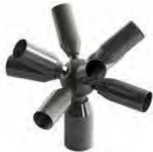
Il giunto tipo di una reticolare spaziale prevede due semisfere in cui vengono facilmente avvitate le teste delle aste convergenti nel nodo con un bullone di misura dipendente dalle forze in gioco. Le due semisfere vengono poi chiuse tra loro. Viste le alte forze in gioco, potrebbe essere necessario prevedere un metodo alternativo di giunzione in quanto un singolo bullone potrebbe non essere necessario.
