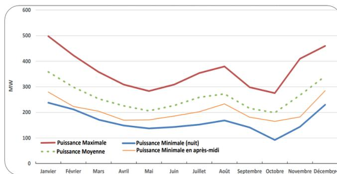
Figure 2 : Puissance appelée sur le réseau Corse en 2017 [5]
