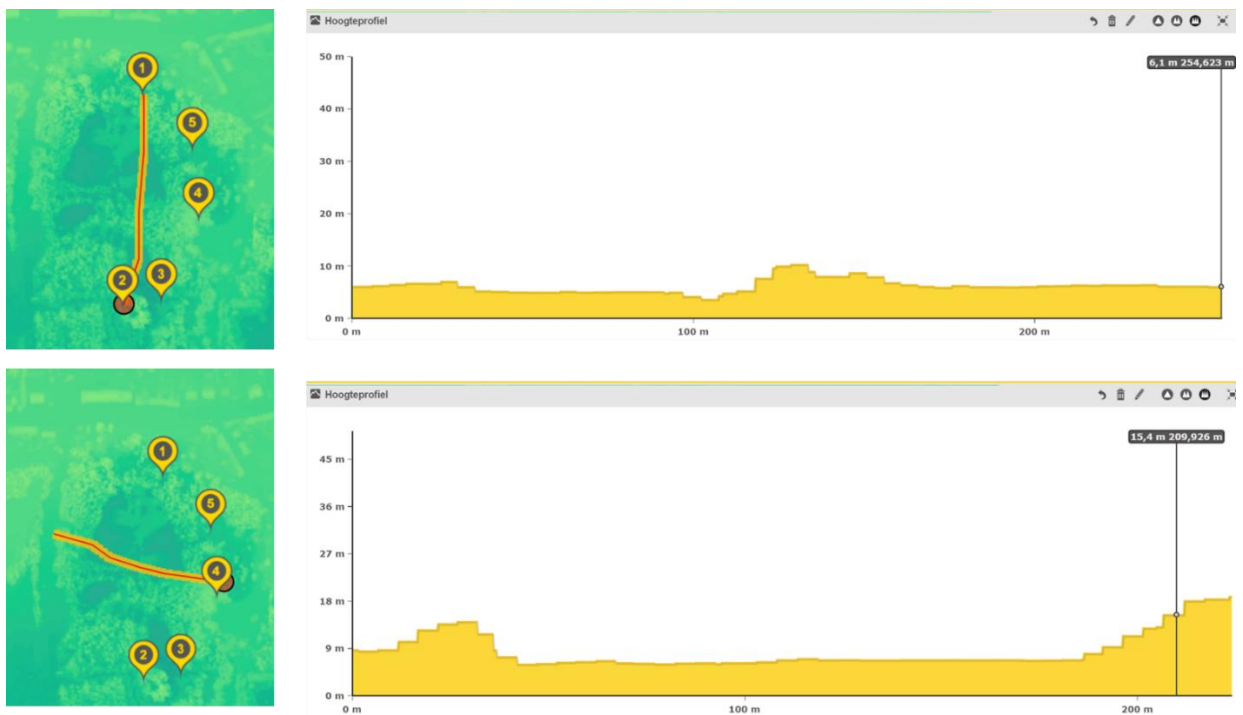
Figuur 16 - Hoogteprofiel van 2 dwarse routes uitgetekend van noord naar zuid (boven) en oost naar west (onder) op het Digitaal Hoogtemodel Vlaanderen II, oppervlaktemodel 1m, van het Gelaagpark (Bron: Geopunt, n.d.)
