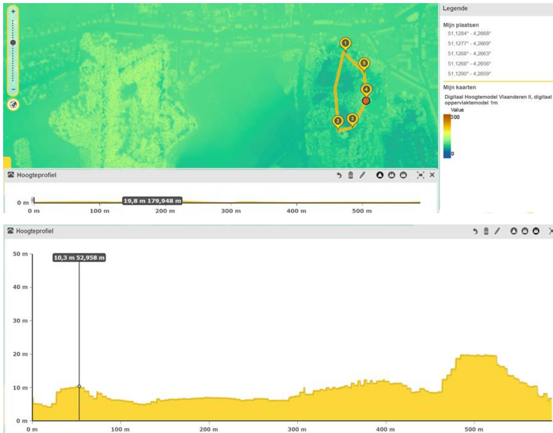
Figuur 15 – Boven: een route uitgetekend via de verschillende coördinaten op het Digitaal Hoogtemodel Vlaanderen II, oppervlaktemodel 1m, in het Gelaagpark; Onder: het bijhorende hoogteprofiel (Bron: Geopunt, n.d.)
